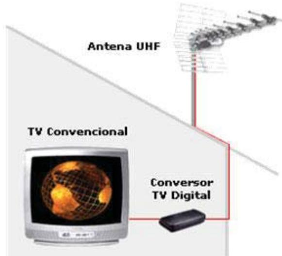
**FIGURA 05:** Ilustração de como será utilizado o conversor de TV Digital em TV Convencional (Disponível em: <<http://www.forumsbtvd.org.br/materias.asp?id=492>>. Acesso: 07 nov. 2010).
