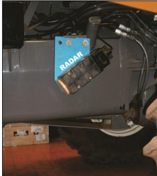
Figura 5. Radar Dick John, alinhado com ângulo de  $45^\circ$  em relação ao solo.
