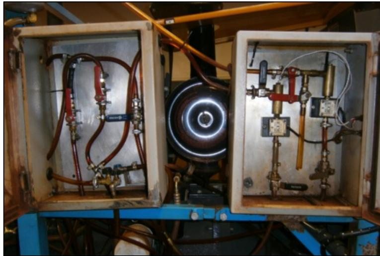
Figura 6. Medidor de fluxo de combustível Oval M – III, modelo LSF41.
