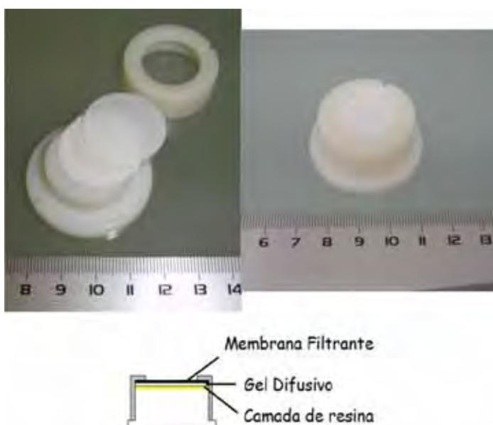
Figura 4. Dispositivos DGT, base e anel de polipropileno (Fonte: Autor, 2010). Esquema de um sistema DGT montados com os dispositivos de polipropileno e os materiais aplicados na técnica (Fonte: Manual Técnico de Informações – DGT Research Ltd).
