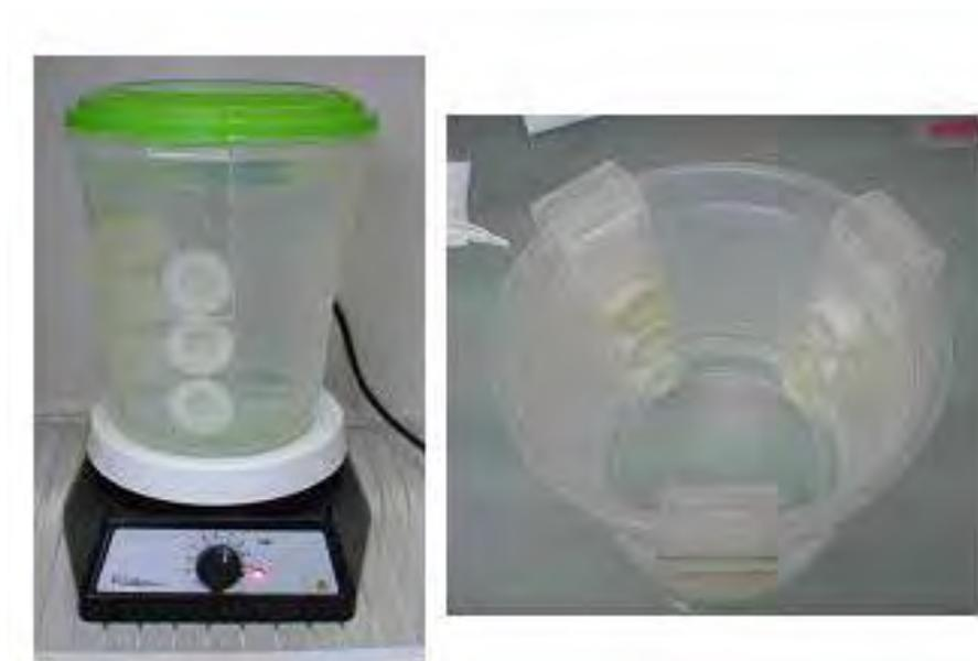
Figura 8. Experimento de imersão para cálculo do coeficiente de difusão e montagem do experimento com os dispositivos presos ao suporte de acrílico (Fonte: Autor, 2011).
