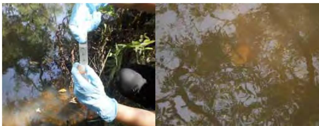
Figura 10. Procedimento de coleta de amostra filtrada para análise da fração dissolvida, ao lado dispositivos DGT imersos no Ribeirão Claro, SP (Fonte: Autor, 2011).
