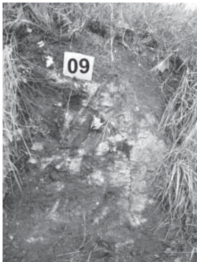
**FOTO 4.** Perfil de solo nº 9, em que se pode observar o preenchimento das fraturas por manganês, que dá cores escuras.
