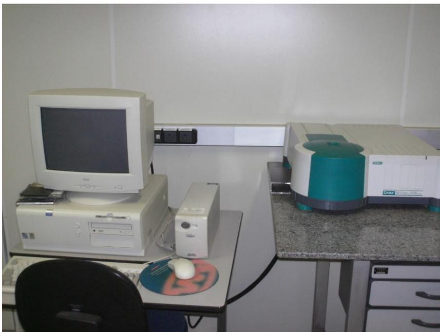
Figura 11: Espectrofotômetro „Varian Cary 50“ utilizado para medidas de absorção.
