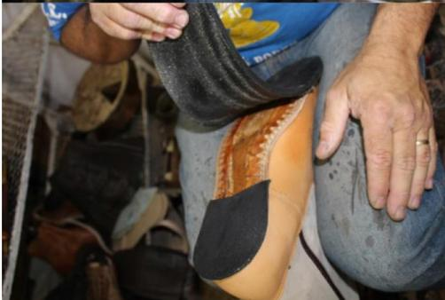
Coloca-se o salto, de couro ou pré-fabricado.
