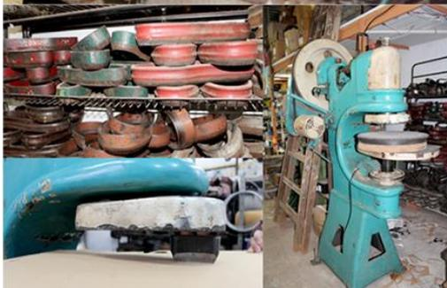
Executa-se o solado: escolhe-se a faca e cortam-se a sola e a palmilha no balancim.
