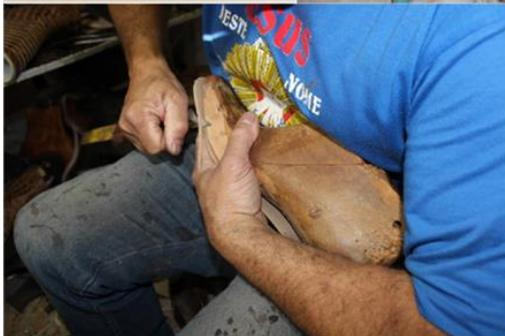
Prepara-se a palmilha, ajustando-a à forma por refilamento.
