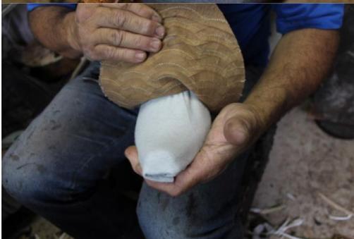
Coloca-se a sola, produzida pelo sapateiro com couro ou pneu, ou feita industrialmente com borracha ou látex.
