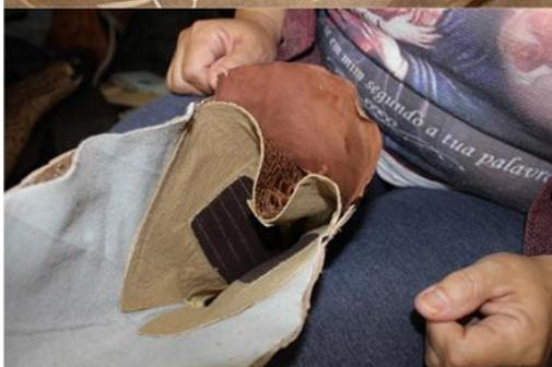
Cola-se o contraforte na parte interna do calçado, na região do calcanhar, entre o cabedal traseiro e o forro.
