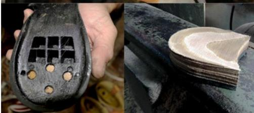
Lixa-se a parte de montagem para fazer a vira, isto é, a parte do acabamento que leva o pesponto sobre uma tira em torno do sapato, cobrindo a beirada da sola
