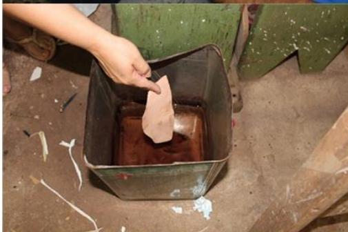
Coloca-se o contraforte (reforço interno de couro) na água para moldá-lo ao calcanhar.
