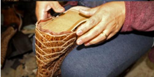
Coloca-se o forro e depois a biqueira, entre a parte superior e o forro.
