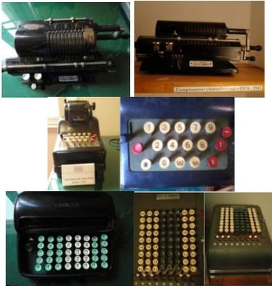
**Figura 4:** Máquinas de Calcular de formas distintas de se operar (máquina de Odhner, Calculadora Astra, Contax e Comptometer).
