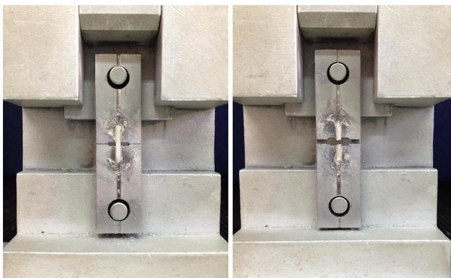
Figura 15 - Ensaio de microtração (antes do carregamento e após a falha da interface de união).
