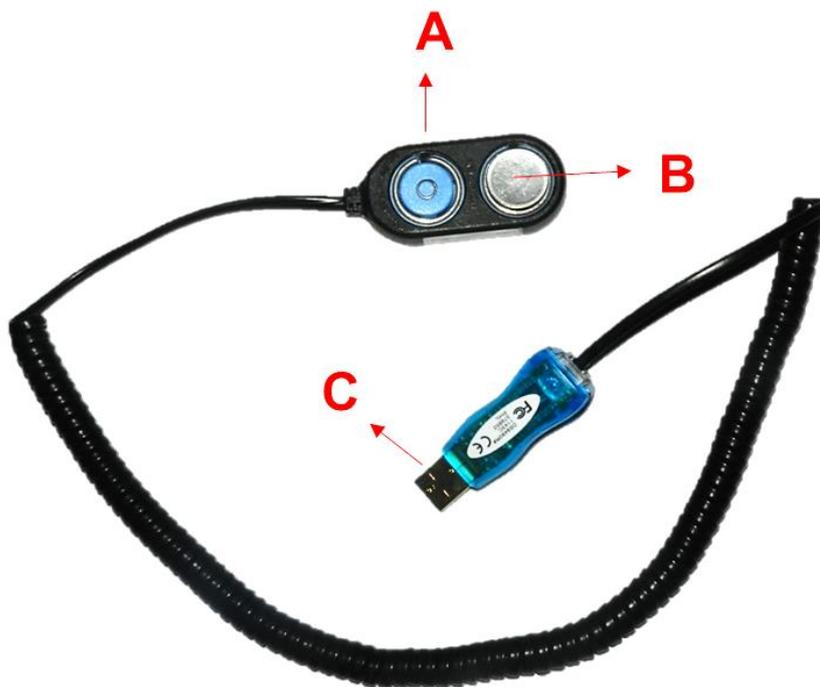
Figura 4 - Dispositivo para leitura do sensor. A) Parte do dispositivo onde existem duas entradas de encaixe para o sensor, para leitura das temperaturas; B) Sensor iButton encaixado no dispositivo; C) Cabo USB para ligação ao software no computador.
