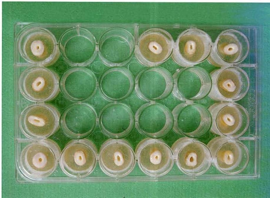
FIGURA 4 – Distribuição e fixação dos espécimes em placas de cultura celular de 24 poços.
