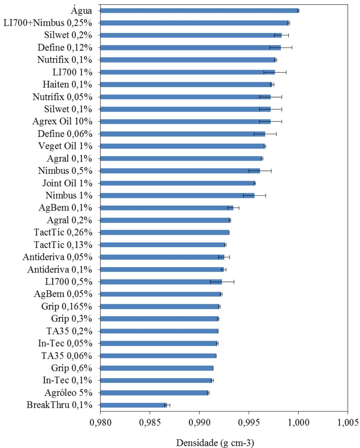
Figura 9. Valores de Densidade (médias  $\pm$  IC<sub>5%</sub>) dos adjuvantes em diferentes concentrações.
