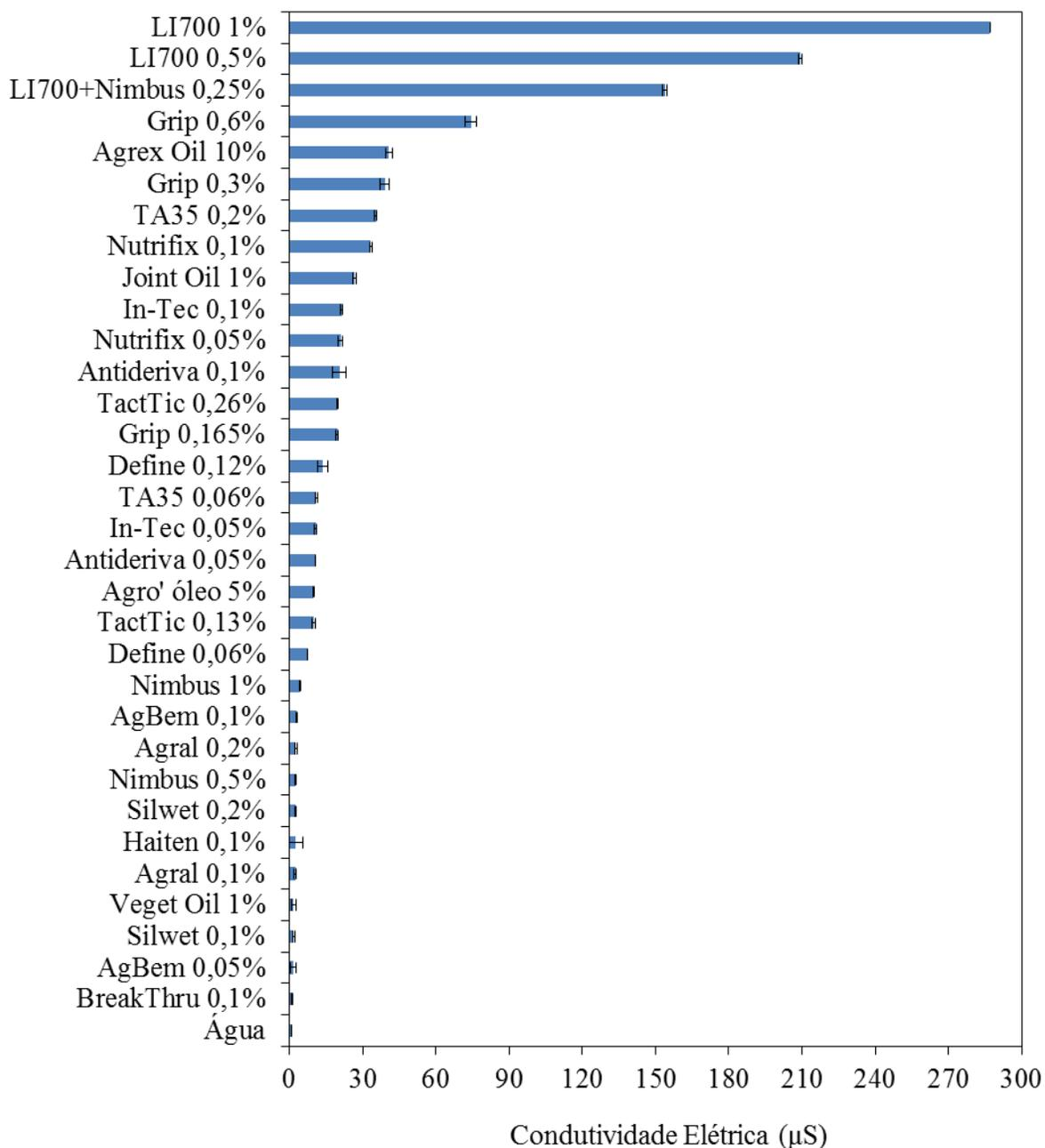
Figura 8. Valores de Condutividade Elétrica (médias  $\pm$  IC<sub>5%</sub>) dos adjuvantes em diferentes concentrações.
