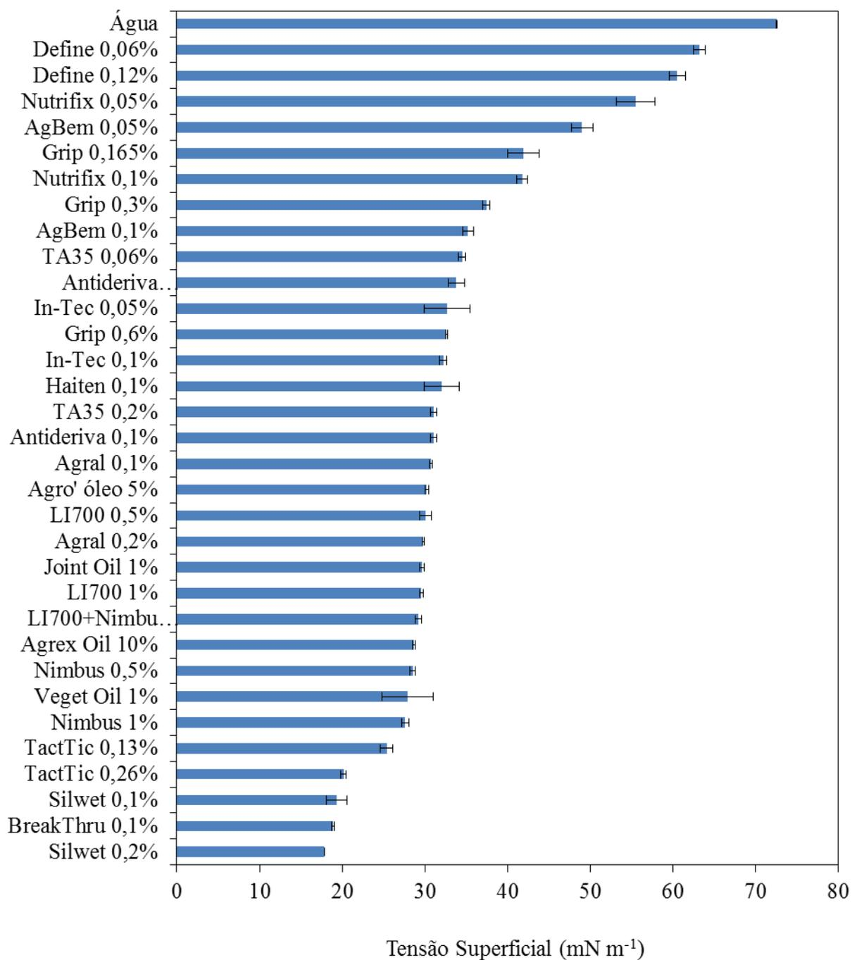
Figura 7. Valores de Tensão Superficial (médias  $\pm$  IC<sub>5%</sub>) dos adjuvantes em diferentes concentrações.
