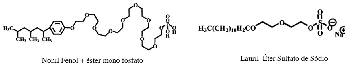
Figura 1. Exemplo da estrutura molecular dos surfactantes aniônicos.
