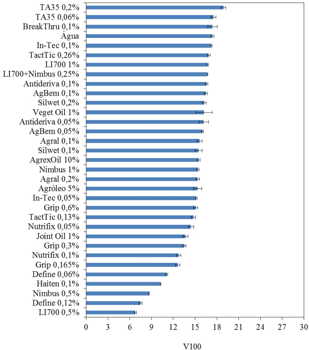
Figura 13. Valores do percentual de gotas menores do que 100  $\mu\text{m}$  (médias  $\pm$  IC<sub>5%</sub>) dos diferentes adjuvantes (ponta XR 8003 VK a 200 kPa).
