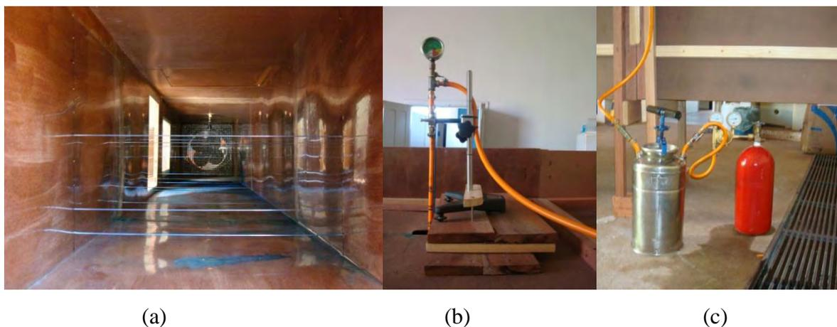
Figura 5. Vista parcial dos coletores dentro do túnel de vento (a), sistema de acionamento da pulverização (b) e tanque de aço inox para o armazenamento e pressurização da calda (c).
