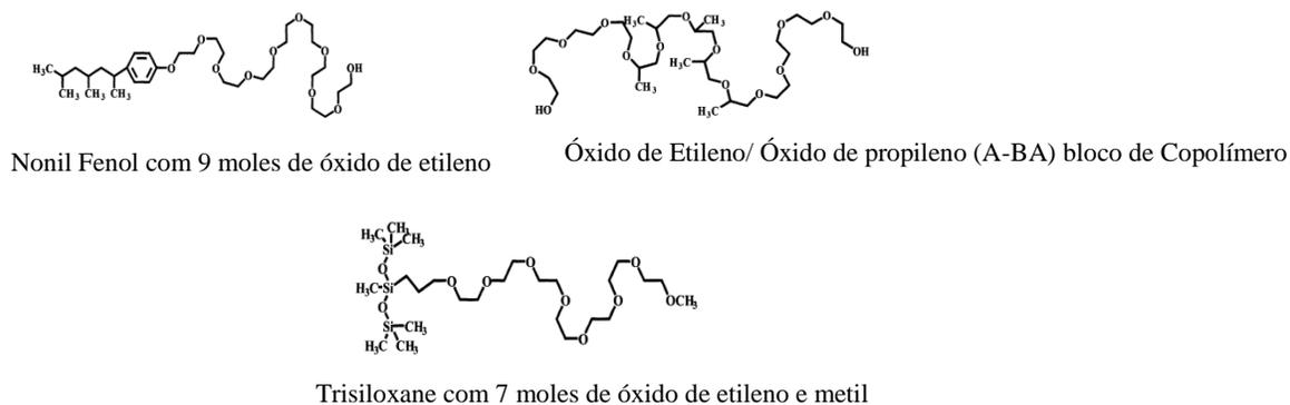
Figura 3. Exemplo das estruturas moleculares dos principais surfatantes não iônicos.
