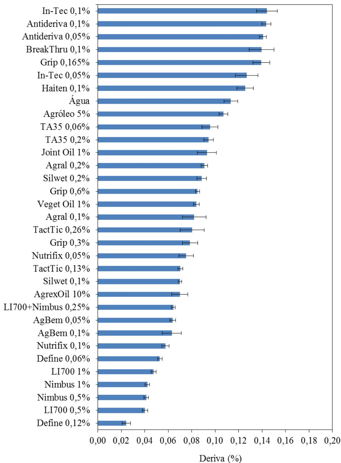
Figura 16. Percentual de Deriva (médias  $\pm$  IC<sub>5%</sub>) proporcionada pelos adjuvantes em diferentes concentrações.
