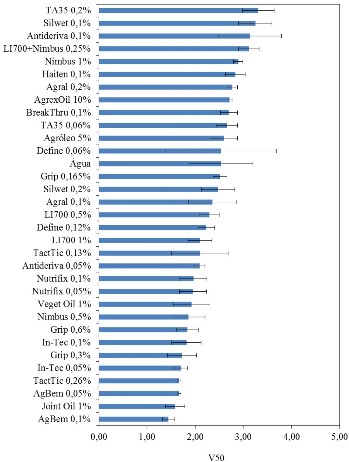
Figura 12. Valores do percentual de gotas menores do que 50  $\mu\text{m}$  (médias  $\pm$  IC<sub>5%</sub>) dos diferentes adjuvantes (ponta XR 8003 VK a 200 kPa).
