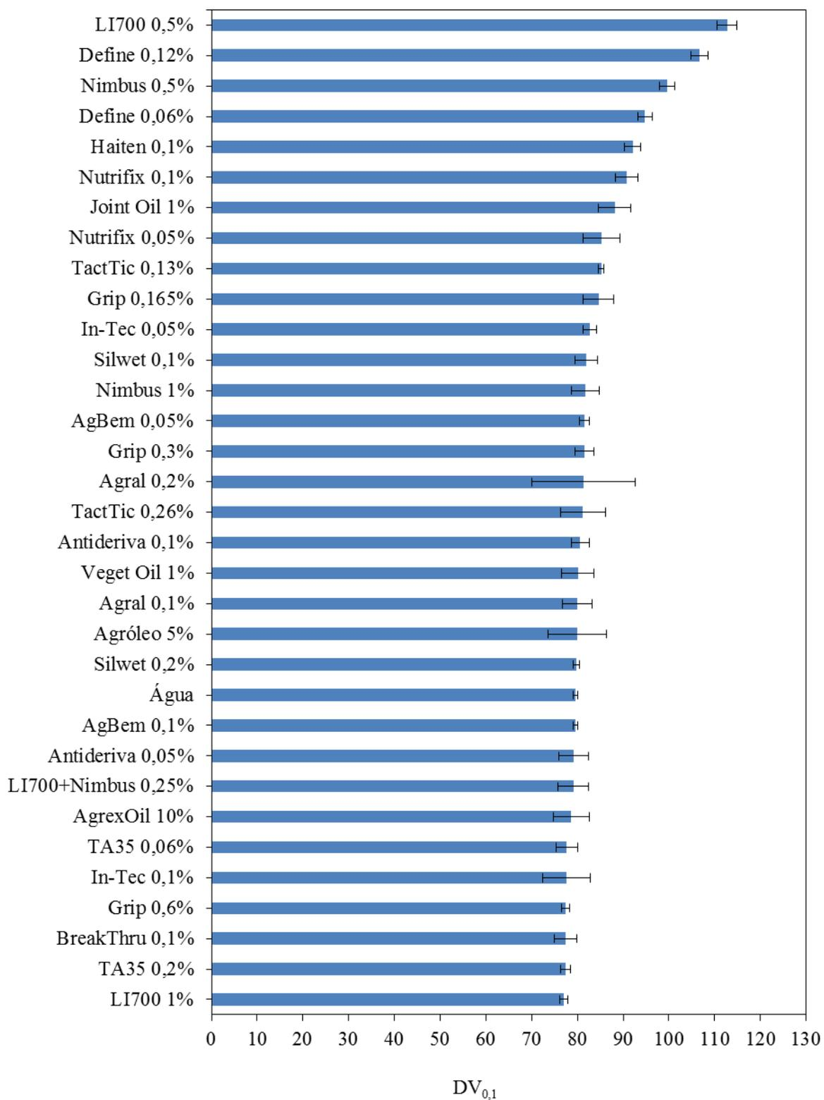
Figura 14. Valores de  $DV_{0,1}$  (médias  $\pm$   $IC_{5\%}$ ) dos adjuvantes em diferentes concentrações (ponta XR 8003 VK a 200 kPa).
