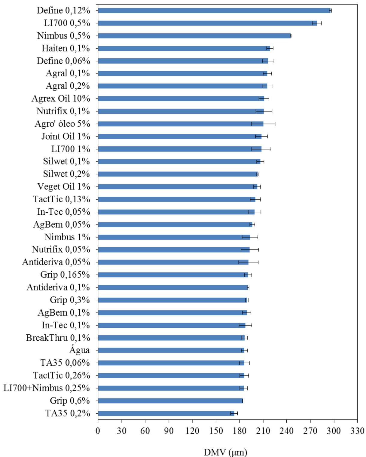
Figura 11. Valores de DMV (médias ± IC<sub>5%</sub>) dos adjuvantes em diferentes concentrações (ponta XR 8003 VK a 200 kPa).
