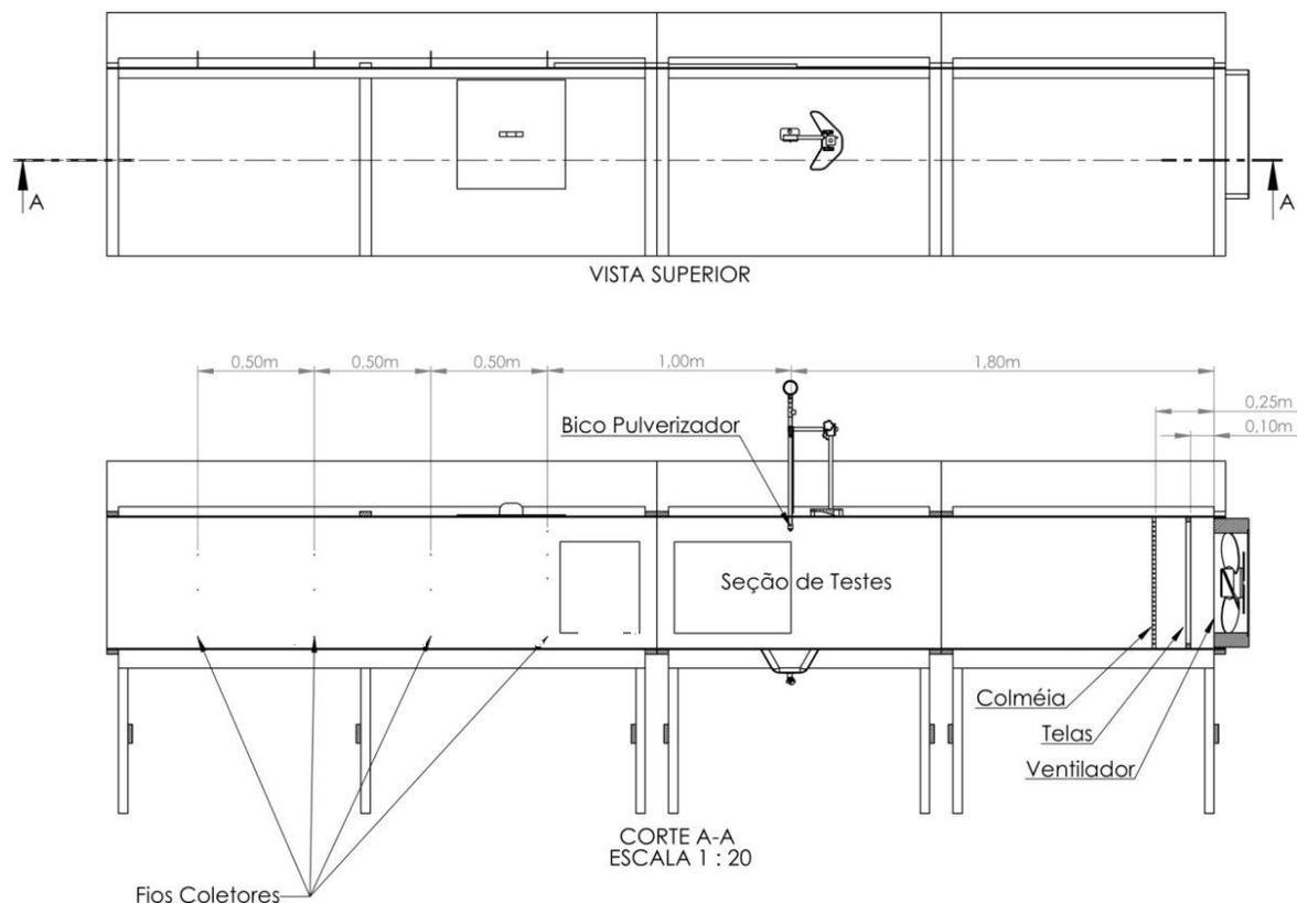
Figura 6. Desenho com vista superior e lateral do túnel de vento e principais componentes.
