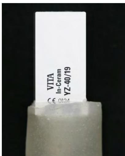
Figura 7 – Bloco de Y-TZP parcialmente embutido na RAAQ.
