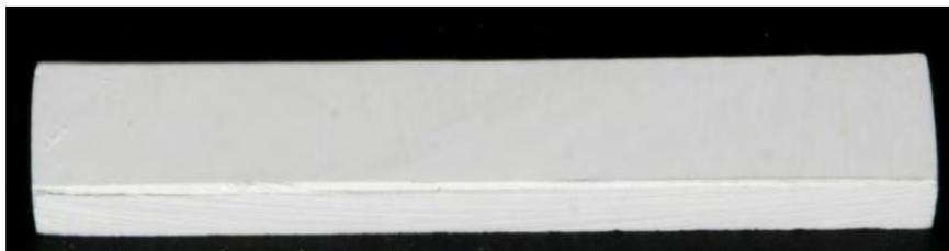
Figura 13 – Dimensões da barra de Y-TZP após sinterização: 20 mm de comprimento; 4 mm de largura; 1,2 mm de espessura.
