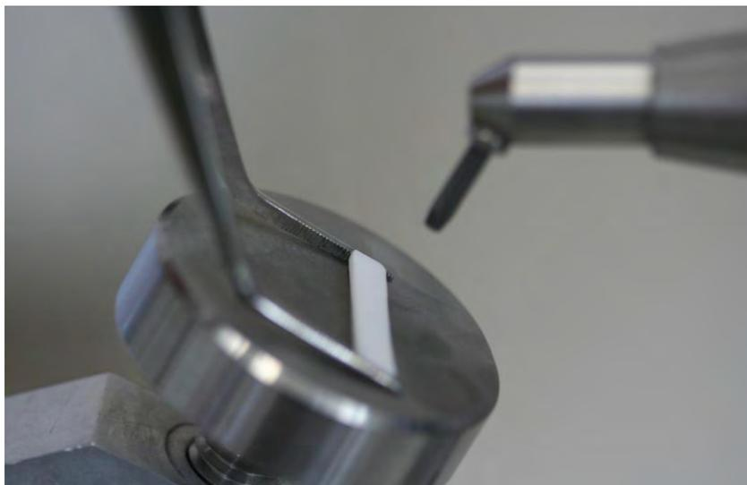
Figura 16 – Jateamento da amostra com distância de 10 mm, 2,8 bars de pressão por 10 s e ângulo de incidência de  $90^{\circ}$ .
