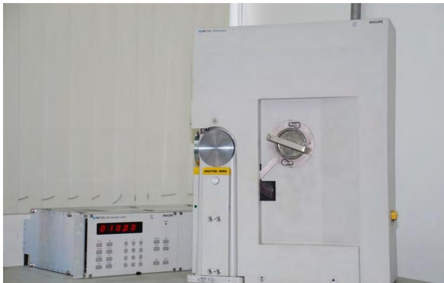
Figura 20- Difratorômetro de Raios-X de alta resolução Philips X'Pert MRD (Laboratório Associado de Sensores e Materiais- LAS/INPE<sup>1</sup>).
