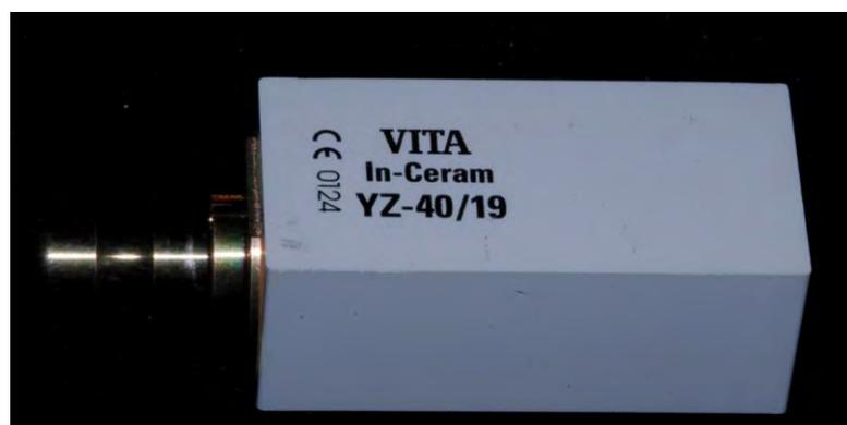
Figura 2 – Apresentação comercial dos blocos de Y-TZP pré-sinterizados (InCeram 2000 YZ Cubes YZ-40/19).
