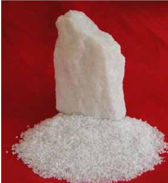
Figura 3 - Alumina calcinada ((RAIA, 2012).
