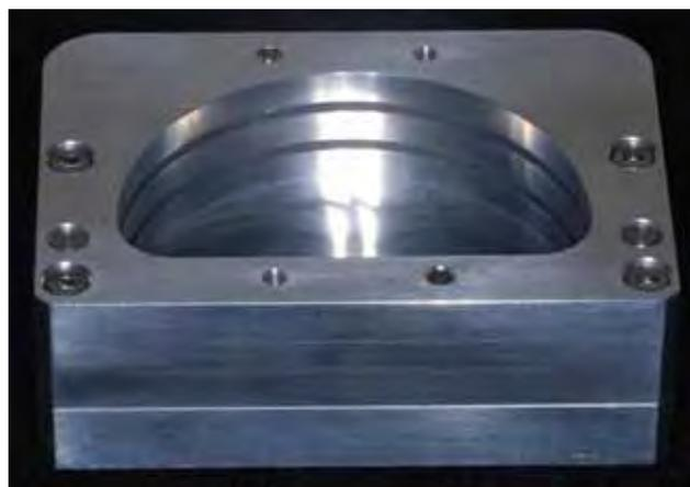
Figura 4 - Matriz metálica montada.
