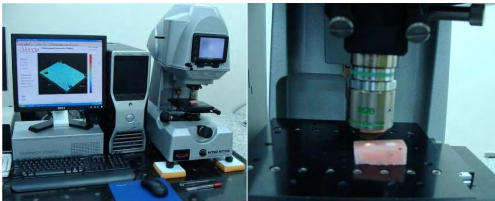
Figura 11 – A) Perfilômetro óptico digital Wyko NT 1100 utilizado para as análises, B) Amostra posicionada no perfilômetro no momento da leitura.
