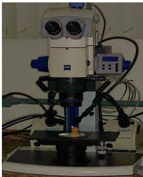
Figura 10 – Estereomicroscópio Zeiss, modelo Discovery V20, durante análise.
