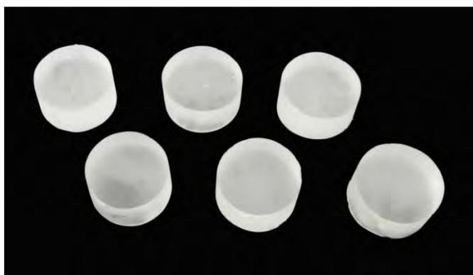
Figura 3 - Corpos de prova, com as devidas dimensões, após acabamento e prontos para receberem o material reembasador.
