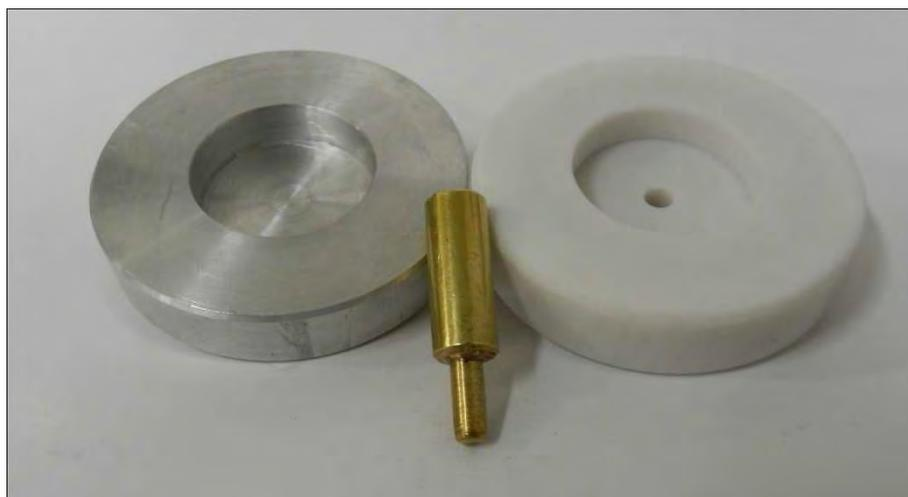
Figura 5 - Matriz de teflon e sua base em alumínio, com o pistão auxiliar para remoção do corpo de prova.
