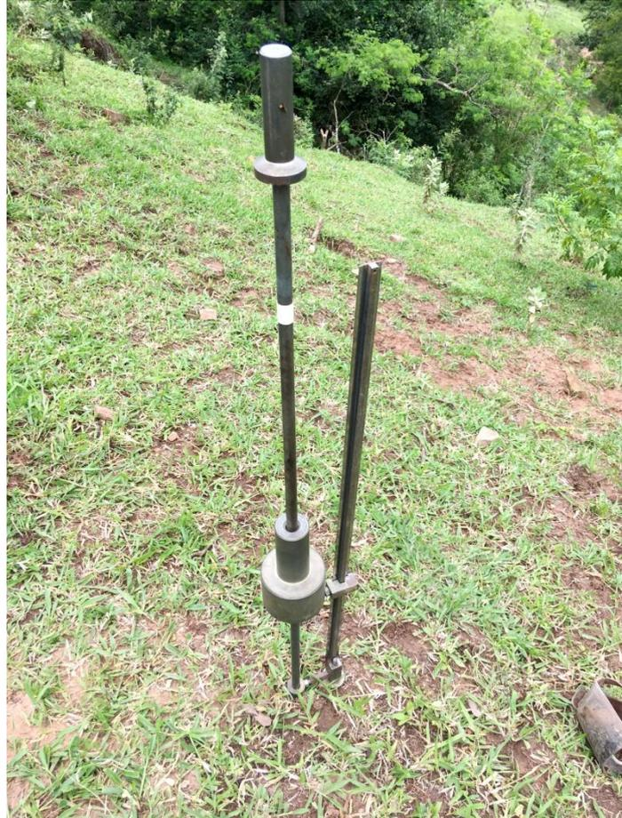
**Figura 10** – Penetrômetro de impacto IAA/Planalsucar-Stolf no ponto de amostragem 29.
