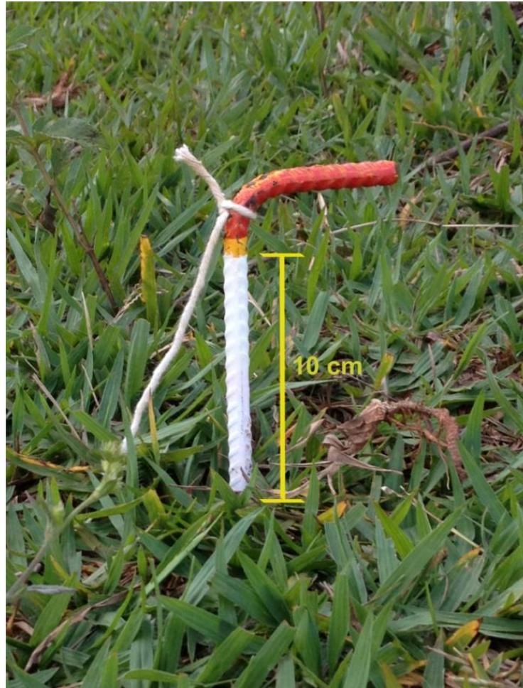
**Figura 6** – Pino de erosão utilizado na área de estudo. O setor branco representa o referencial para os monitoramentos de perda ou acúmulo de solo na superfície próxima ao pino. A mensuração da informação foi realizada sistematicamente no lado esquerdo do pino, considerando a face do pesquisador voltada para o talude da voçoroca.
