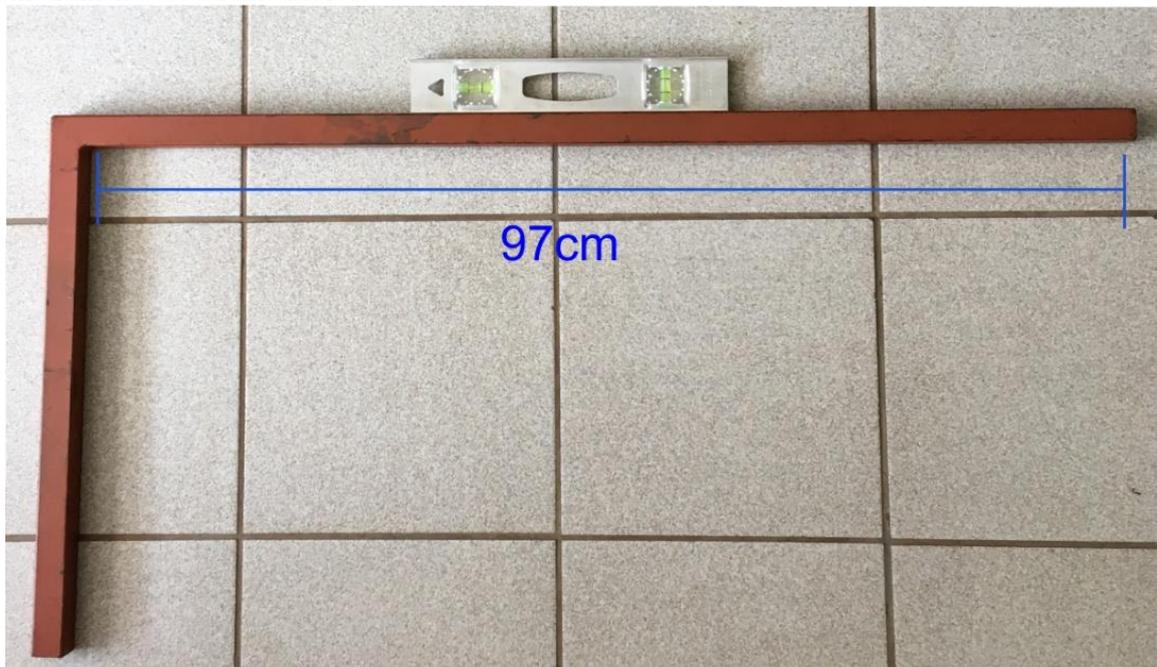
**Figura 5** – Esquadro com nível acoplado para instalação das estacas e monitoramento do talude erosivo.
