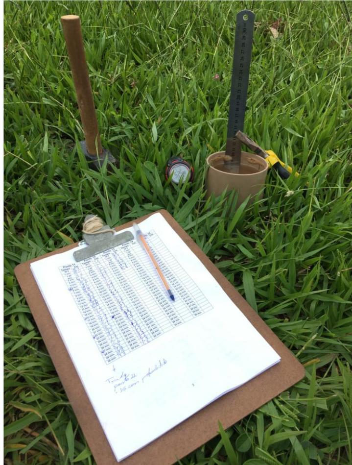
**Figura 9** – Infiltrômetro instalado em campo para realização do experimento no ponto de amostragem 13.
