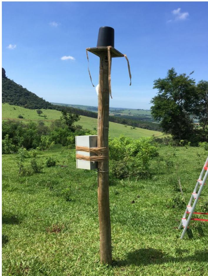
**Figura 7** – Pluviômetro digital modelo Davis 7852 instalado na área de estudo.
