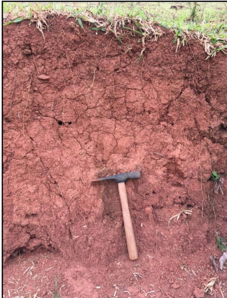
**Figura 18** – Fendas de ressecamento em perfil exposto em campo. Foto tirada em área próxima ao Ponto 19.
