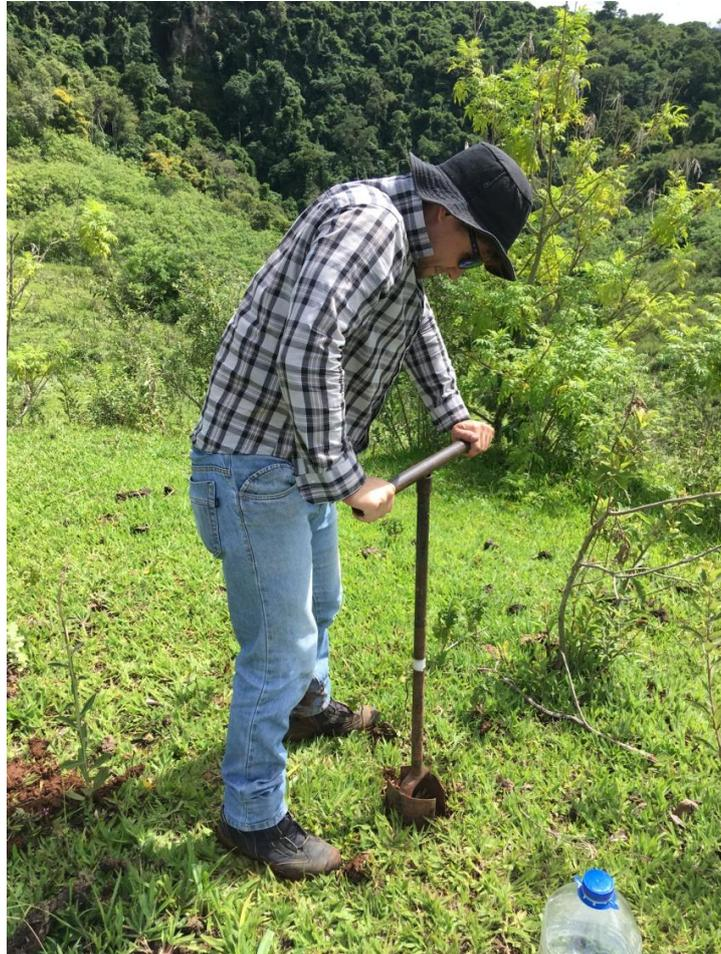
**Figura 11** - Tradagem em campo para coleta de material para análise granulométrica e de permeabilidade do ponto amostral 36.
