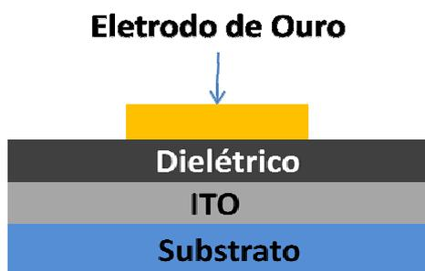
Figura 3.5 – Esquema da estrutura do capacitor MIM (metal-isolante-metal) obtido após evaporação do eletrodo superior de ouro.
