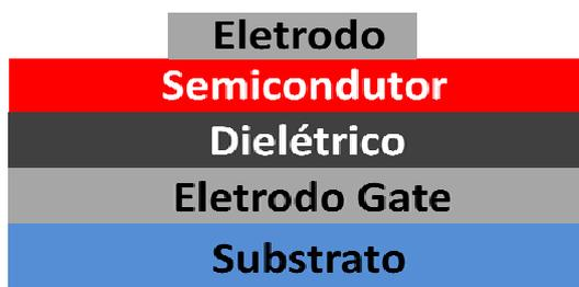
**Figura 1.1 – Esquema de um capacitor MIS.**
