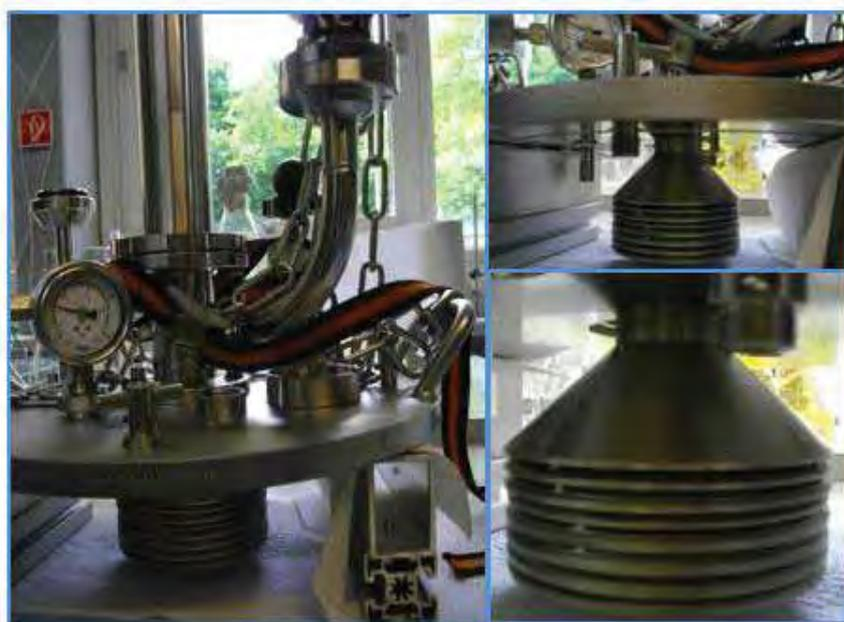
**Figura 5.1** - Quebrador mecânico de espuma acoplado ao fermentador Biostat Cplus - 421
