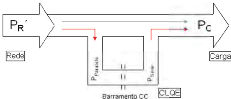
Figura 3.2 - Fluxo de Potência Ativa durante Afundamentos de tensão.
