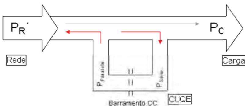
Figura 3.3 - Fluxo de Potência Ativa durante elevação de tensão.
