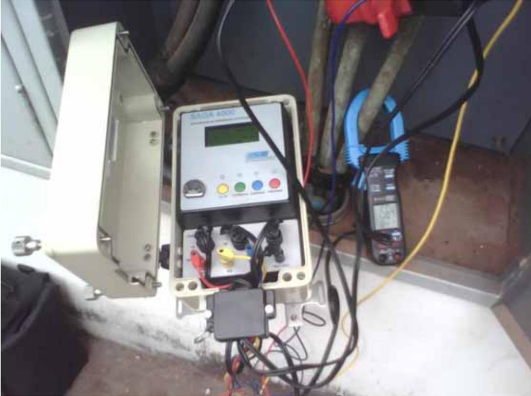
Figura 28. Instalação do Aparelho SAGA no Quadro de Energia
