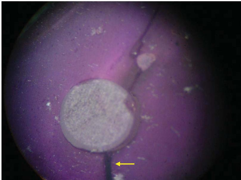
Figura 15 - Foto ilustrando o tipo de falha coesiva.
