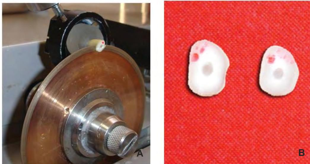
Figura 8 – A) corte das raízes para obtenção das fatias; B) fatias com a face coronária demarcada, para correto posicionamento durante o ensaio.
