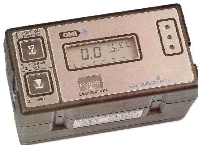
Figura 15 - Gás detector ou explosímetro Fonte: ENGIBRAS, 2004.
