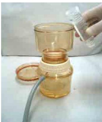
FIGURA 16- Unidade de filtração sob vácuo.
