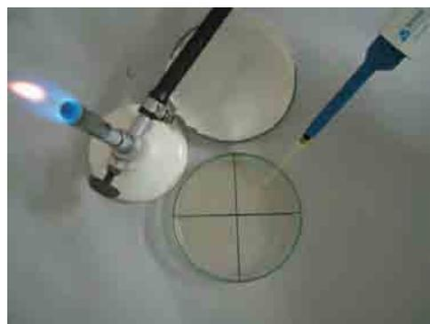
FIGURA 12- Semeadura em placa de Petri contendo ASD.
