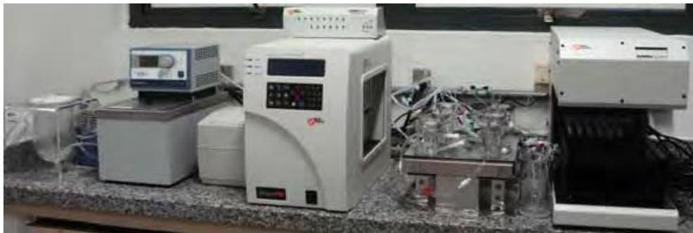
Figura 2 – Sistema automático com célula de difusão vertical de Franz – Microette Plus.
