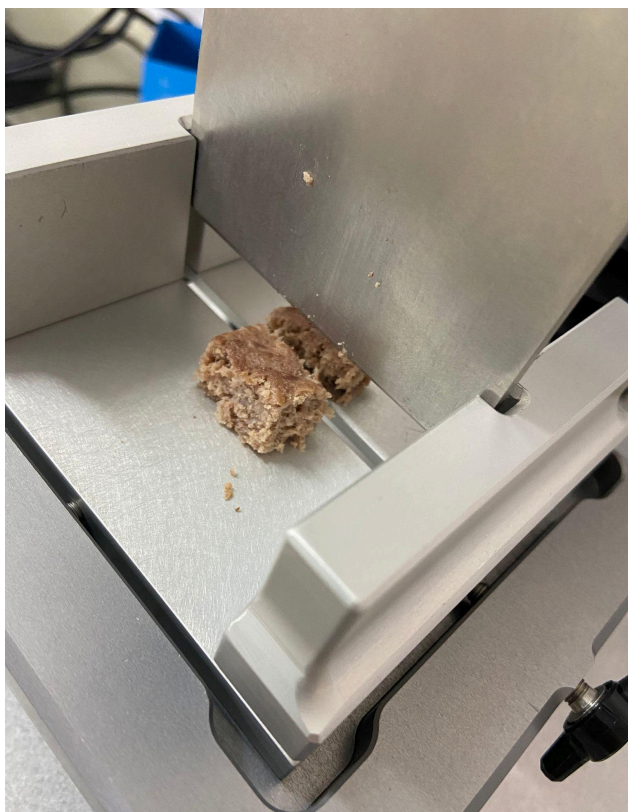
Figura 9 - Texturômetro com a probe guilhotina
