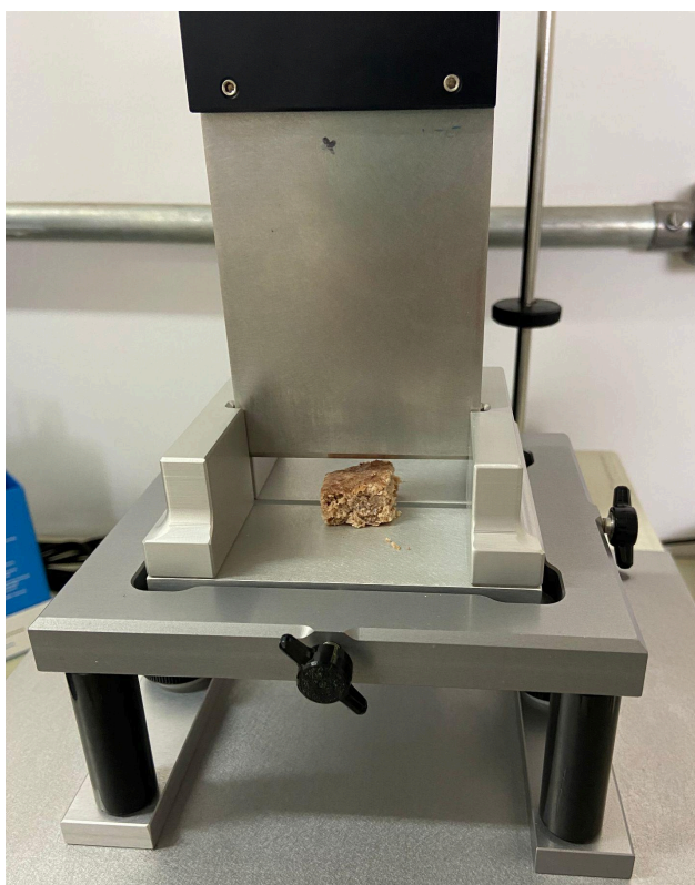
Figura 8 - Texturômetro com a probe guilhotina
